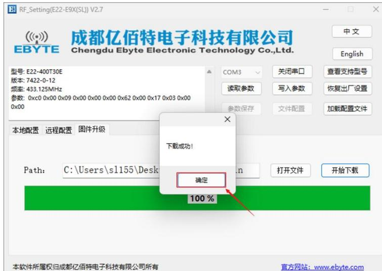
上位机指令升级逻辑：上位机发送：“AT+IAP”，模块回复：“AT+IAP=OK”，等待模块自动复位进入 IAP 升级模式。串口输出“C”字符表示模块等待接收固件 bin 文件，上位机检测到字符“C”后，开始自动分包发送 bin 文件。模块接收完成后，自动复位进入应用程序，升级完成。
