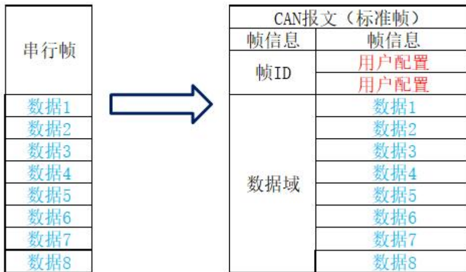
图 4.5 串行帧转换成 CAN 报文 (透传带信息)
