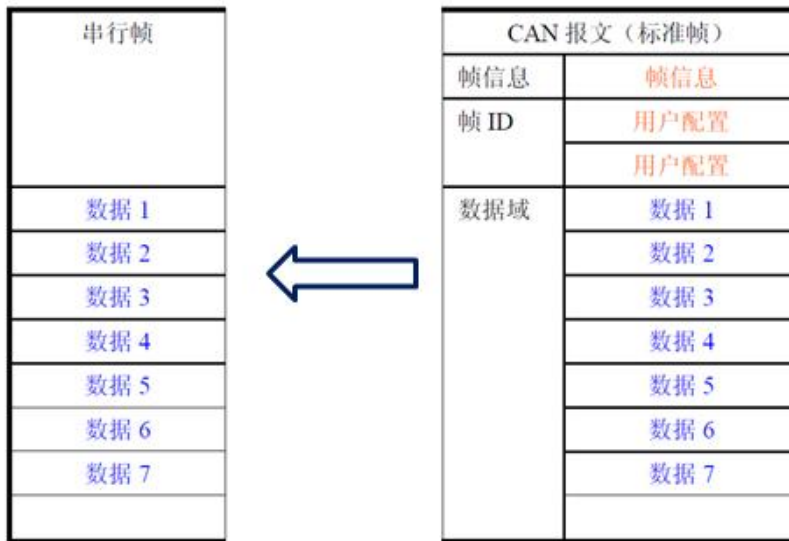
图 4.3 CAN 报文转换成串行帧（透明转换）
