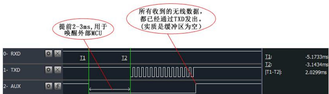
模块串口外发数据时，AUX引脚时序图
