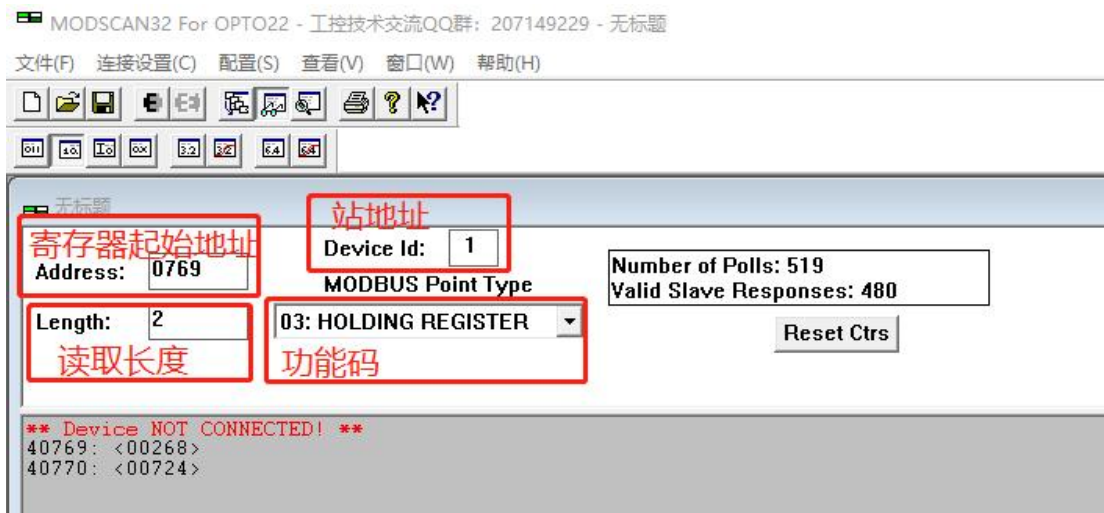
图 1-8 modbus scan软件使用
