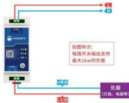
直接负载接线图(经典版带湿节点)
