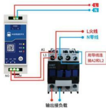
接220V接触器接线图(经典版)
