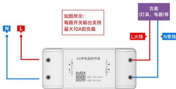
CE31-S01AX、CE31-S01ATX 输出接线图
