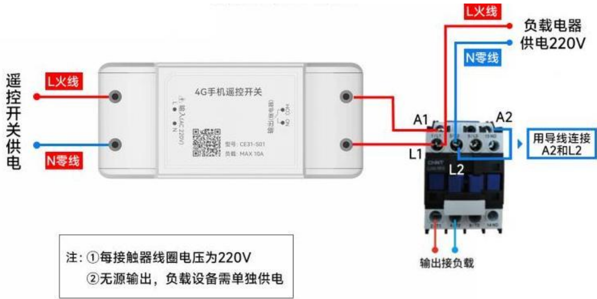
CE31-S01 外接 220V 接触器接线图
