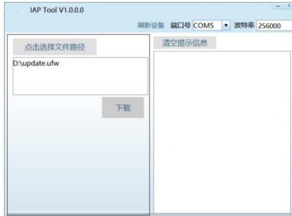
图 4-13 E54-24LD12D 固件升级工具
