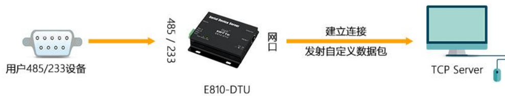
图 5-2 连接时发送自定义数据
