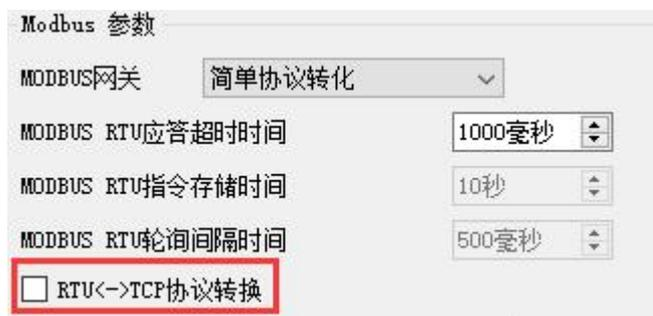
启用：将 Modbus RTU 协议与 Modbus TCP 协议进行互转。
