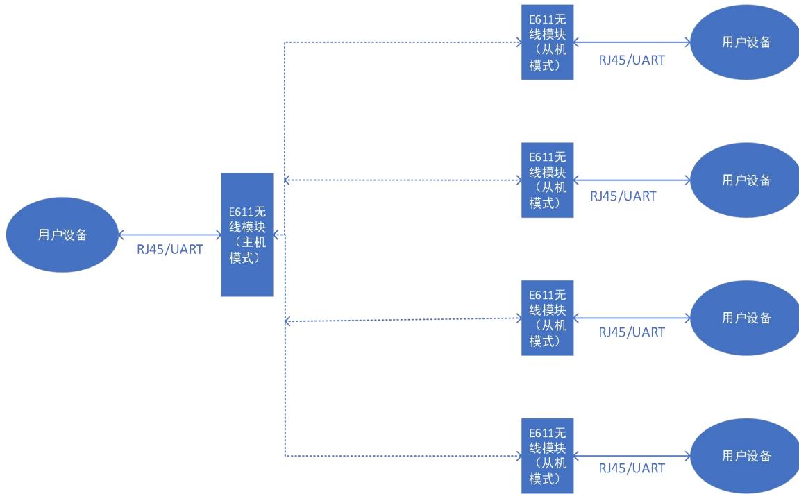
该产品实际组网类型为星形组网，由一个主机设备，和若干个从机节点组成，单个主机节点可支持 8 个从机设备。具体组网演示示例请参考官网视频。
