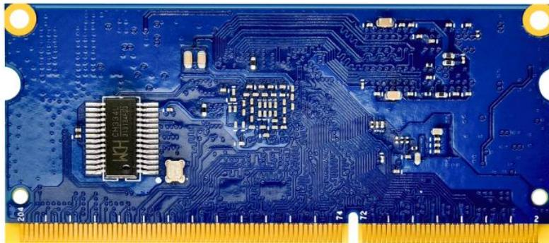
图 1.3 核心板实物背面图
