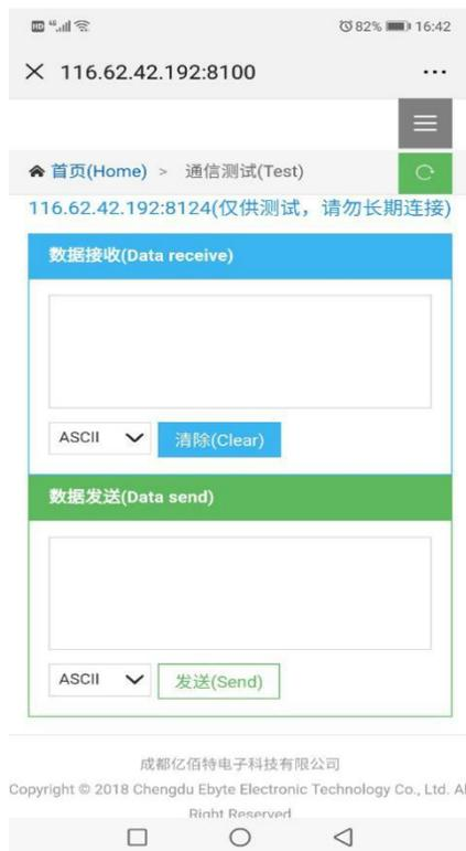
8. 使用串口助手发送数据给 E70-433NWxx 模块，若 E70-DTU (433NW30-4G) 接收到 E70-433NWxx 发送的数据，则 WORK 指示灯闪烁，且将接收到的数据发送至服务器，通讯测试结果如下图所示：
