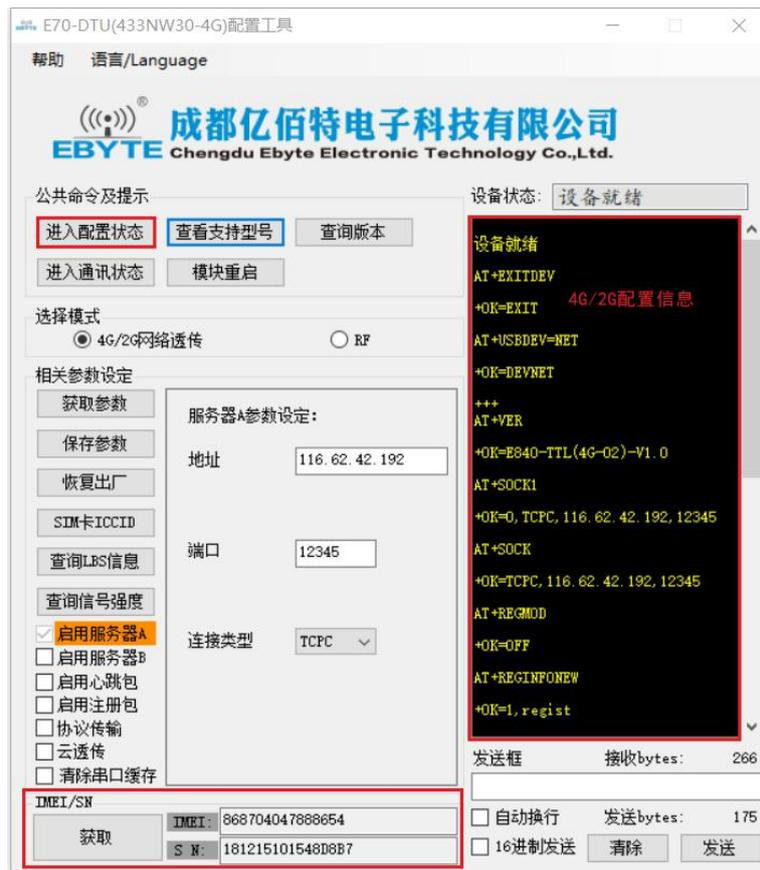
3. 进入 4G/2G 网络透传配置模式后，即可在“相关参数设定”框中配置 4G/2G 模块的参数，配置完成后，点击“保存参数”按钮，上位机将提示“保存所有参数成功”。完成后如下图所示：
