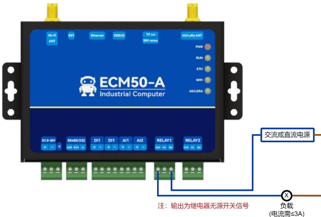
如上图所示, 用户可以在一个回路中接上电源和用电器, 那么直接控制 DO 信号就可以来控制改回路的通断。
