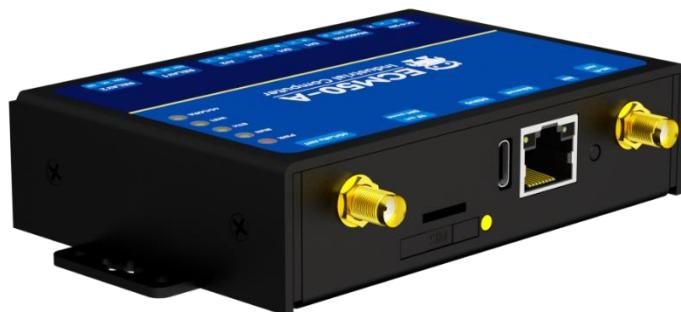
如果需要长期稳定的供电，或者需要使用 4G 等用电需求大的外设时，需要连接 DC 供电，位置在连接端子的最左侧，丝印为 DC8~28V。
