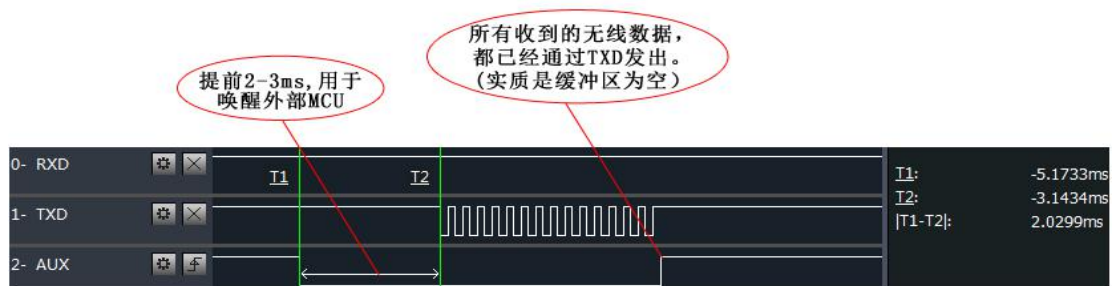
模块串口外发数据时，AUX引脚时序图
