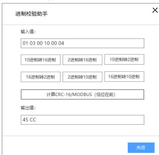
图 4.1 上位机 CRC-16/MODBUS 校验计算
