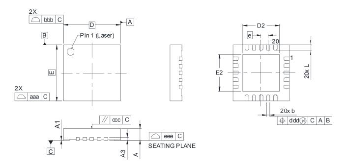
Figure 15. 20-Pin Quad Flat No-Lead (QFN)
