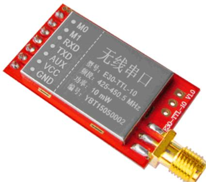
E30-TTL-10 是一款 433M 直插型无线串口模块 ( UART ) , 半双工 , 收发一体 , 透明传输方式 , 发射功率 10mW , 工作在 425~450.5MHz 频段 ( 默认 433MHz ) , TTL 电平输出 , 兼容 3.3V 与 5V 的 IO 口电压 , 具有空中唤醒功能 ( 超低功耗 ) 。
