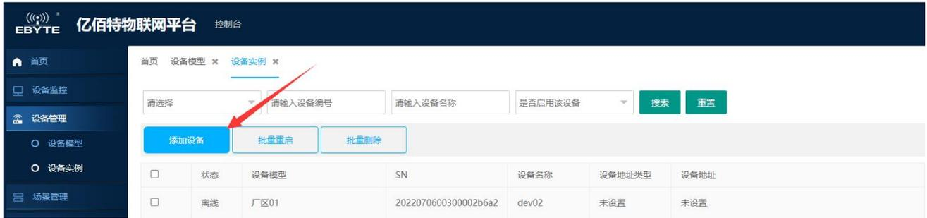
⑤ “设备模型”选择之前创建的 E870-G1 模型，然后输入设备背面的 SN 码，其他参数按照自己需求填写，点击“确定添加”即可创建设备。
