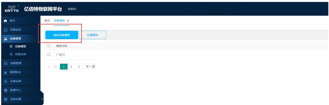
③输入相关参数，点击“添加从机”，选择“亿佰特云 IO”，“内置 IO”，“E870-G1”，输入从机名称后点击“保存”，在点击“确认添加”，即可创建设备模型。
