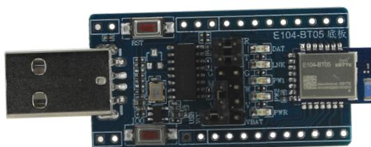
E104-BT05-TB 测试底板采用 USB 接口，可用于快速测试 E104-BT05 蓝牙相关特性与功能。
