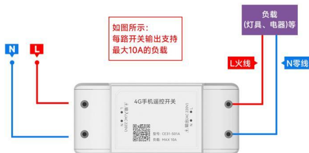
图 2-2-3 CE31-S01A 输出接线图
