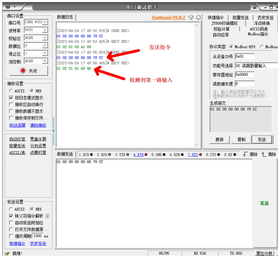
读离散输入效果示意图
