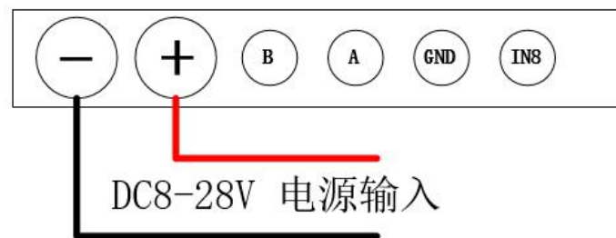
远程 IO 连接示意图
