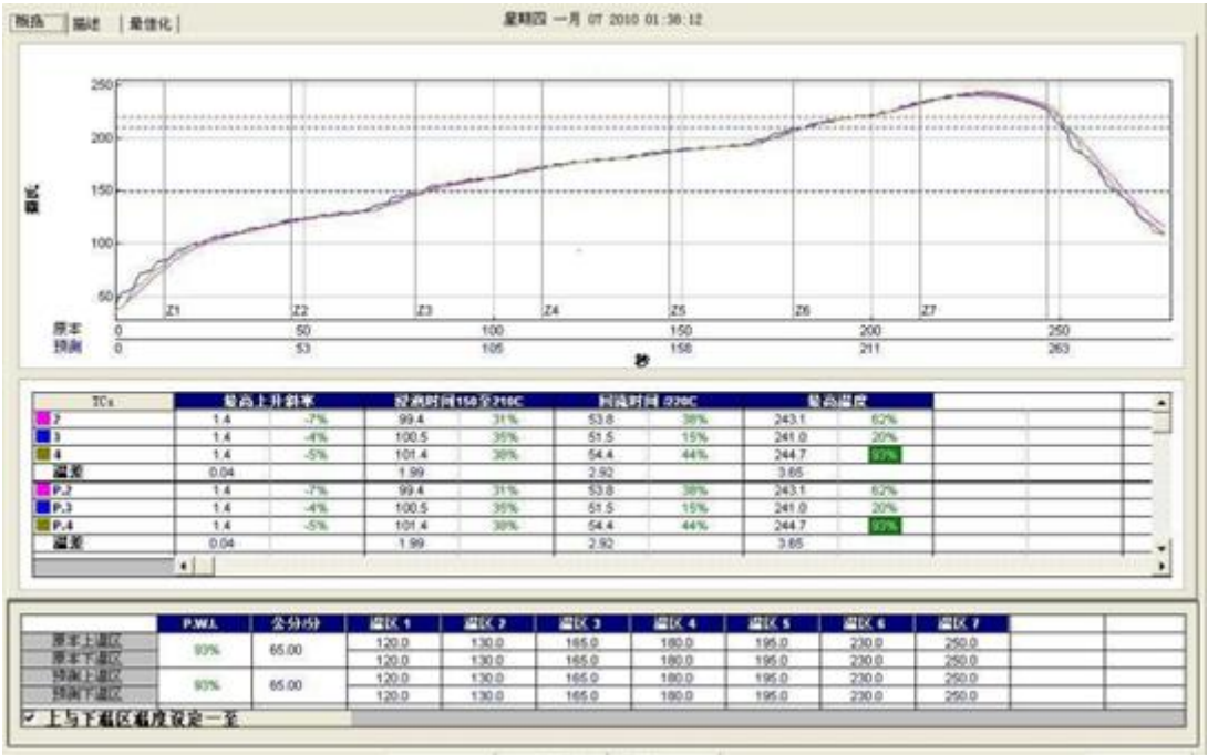
图 24：YBT-G01 推荐焊接炉温曲线图
