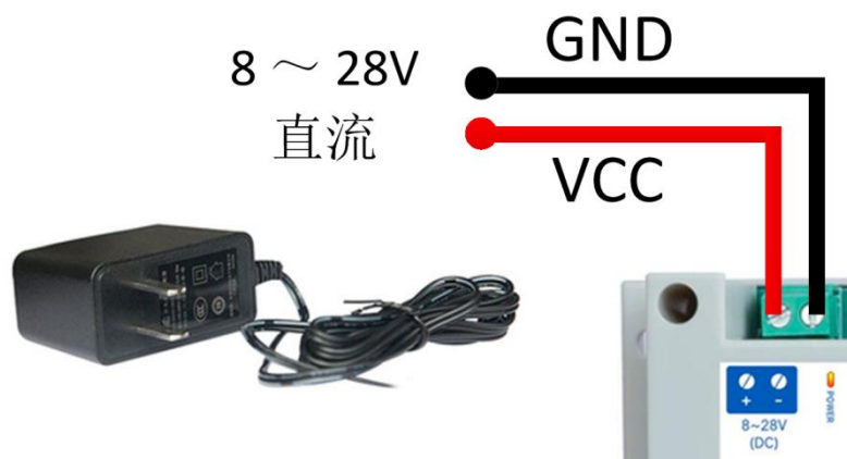
图 2-2-1 电源接线图
