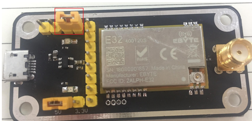
如图所示，插接好跳线帽（选择 5V 供电，模式 1），具体功能请参照明相应的串口模块手册。
